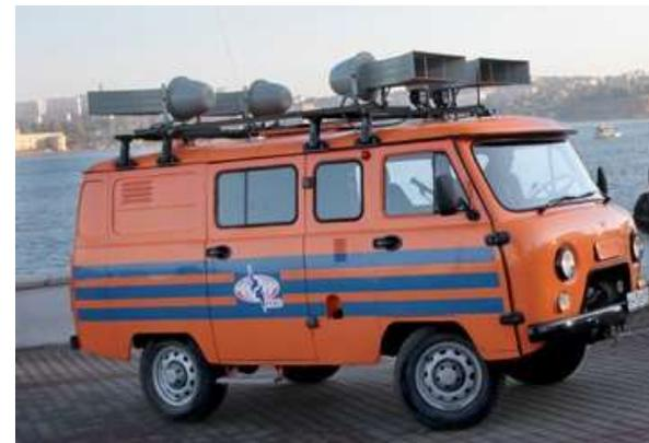
**Оповещение проводится методом подачи сигнала «Внимание Всем» с помощью акустических систем и передачи речевого сообщения (в т.ч. заранее записанного)**
